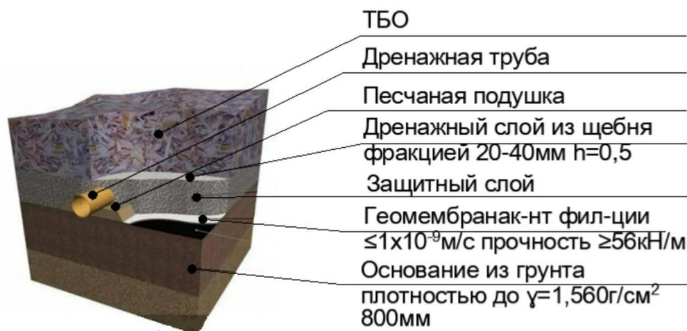
Рисунок 5.1.4. Схема конструкции защитного экрана карты ТБО
